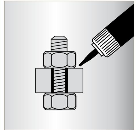
Parker-Schraubensicherungen der TL-Serie sind hochwertige anaerobe Kleb- und Dichtstoffe auf der Basis spezieller Methacrylatharze. Sie wurden eigens konzipiert zum wirtschaftlichen Sichern, Befestigen und Dichten von Schraubverbindungen.
