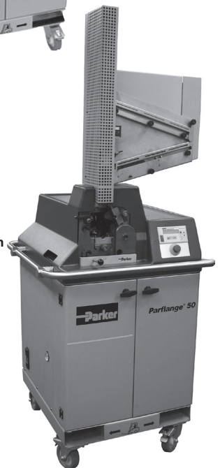
Parflange® 50 PRO für die Massenproduktion von O-Lok®- Verschraubungen
