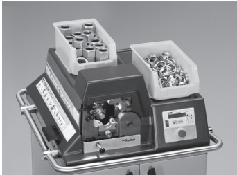
Behälter können auf den Plattformen gelagert werden
