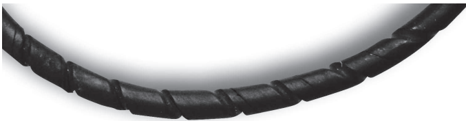
Bild 9.10 Verdrehter O-Ring mit spiralförmigen Markierungen
