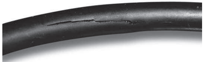
Bild 9.12 Oberflächenzerstörung durch explosive Dekompression
