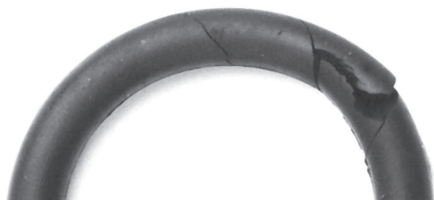
Bild 9.11 Verdrehter O-Ring mit Einschnitten in der O-Ring-Oberfläche
