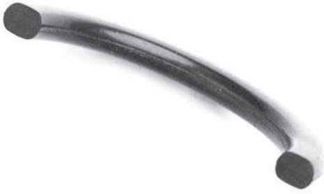
Bild 9.9 Schadensbild durch hohe bleibende Verformung (Compression Set)
