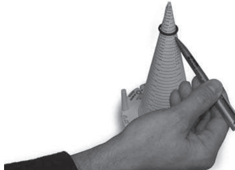
Bestimmung der Größe mit dem Meßkegel
