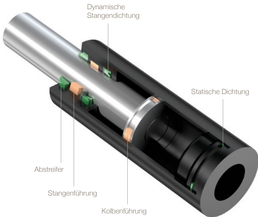
Dichtsystem einer Industrie-Gasfeder
