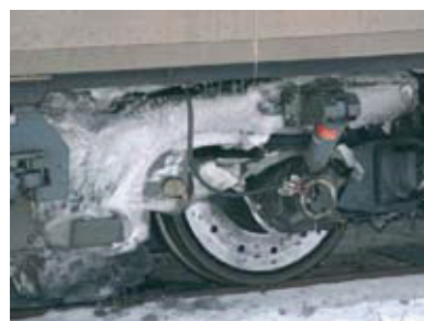
Feuchte Druckluft lässt Eis entstehen.
