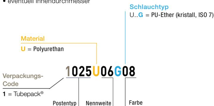
**Code für Nennweite:** entspricht dem Außendurchmesser.
