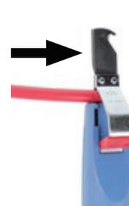
5. Ziehen Sie das Werkzeug ans Schlauchende, um die Ummantlung längs zu schlitzeln.
