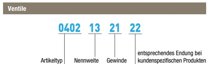
**Code für Nennweite:** Entspricht dem Rohr-/Schlauchaußendurchmesser.
