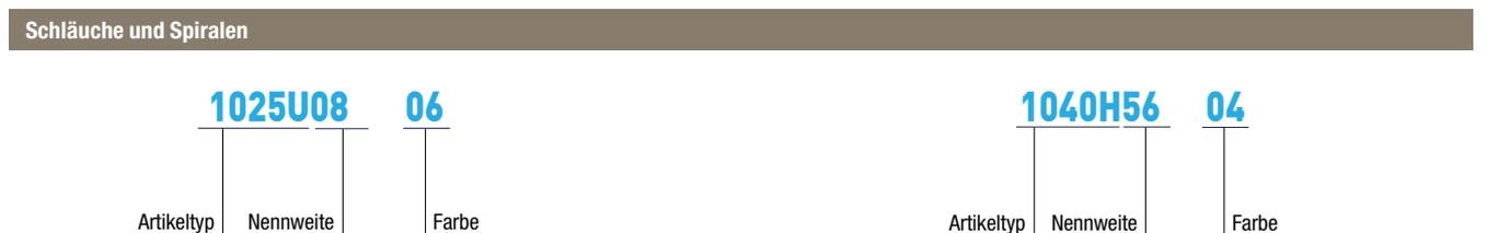
**Code für Nennweite:** Entspricht dem Außendurchmesser.
