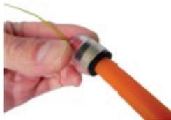
2. Schieben Sie den Verbinder über den Mikroschlauch.
