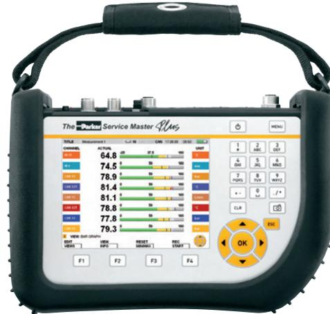
Druck, Volumenstrom und Temperaturmessung mit Parker Serviceman Plus, The Parker Service Master *Easy* SCM-330/340 oder Service Master *Plus* SCM-500-01-xx und Hydrauliktester SCLV-PTQ
