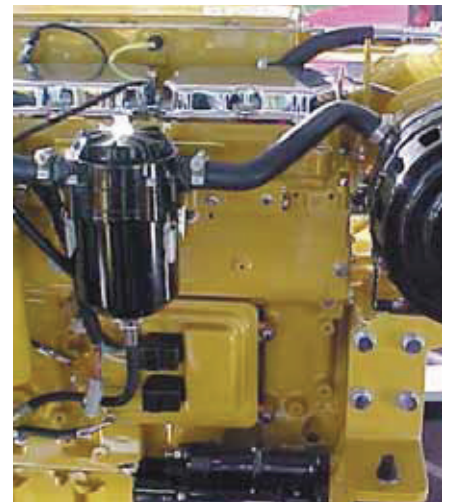
Nachstehende Abbildungen: (links) Cummins QSM11 Schiffsmotor mit CCV-Schnittmodell. (rechts) Caterpillar 3196 Schiffsmotor mit Racor Luftfilter und CCV.
