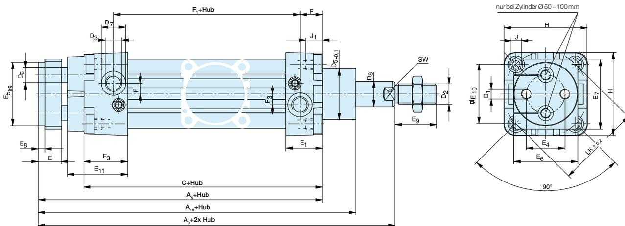
Abmessungen – Grundzylinder verdrehgesichert, mit durchgehenden Kolbenstangen, Baureihe AZ4...., Ø 32 – 100 mm
