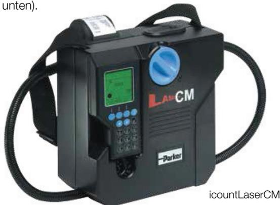
Die Partikelzähler von Parker sind bekannt für ihre zuverlässige Leistung vor Ort oder im Rahmen einer Produktionsanlage. Leichte, tragbare Partikelzähler dienen der vorübergehenden Messung der Fluid-Reinheit.
